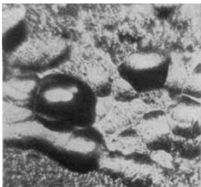
Abb. 6. Schwammversilberung über elektrolytisch reduziertem Kupferoxyduleinschluß. Die linke untere Ecke zeigt normale Versilberung. 640×.
