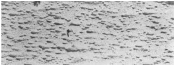
Abb. 4. Gleiches Grundmetall wie Abb. 2 und 3, aber ungeglüht, Walzgrad etwa 50%. Versilberungsfehler sind in der Walzrichtung orientiert. 15×.
