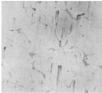
Abb. 2. Geglühtes Silber-Kupfer-Blech mit 0,2% P vor der Entfettung und Versilberung. 280×.
